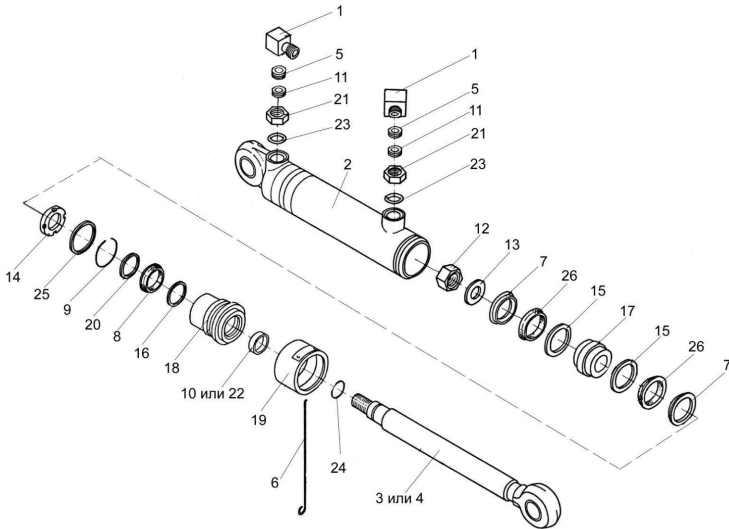
Рисунок 16 – Гидроцилиндр ПКК 0113200-03
