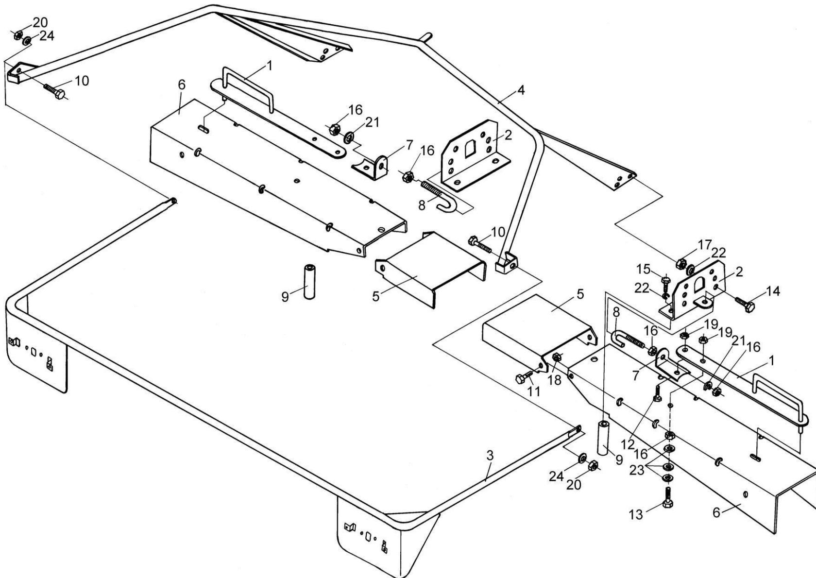
Рисунок 83 – Брус заламывающий ПКК 0206030, ограждение ременной передачи
