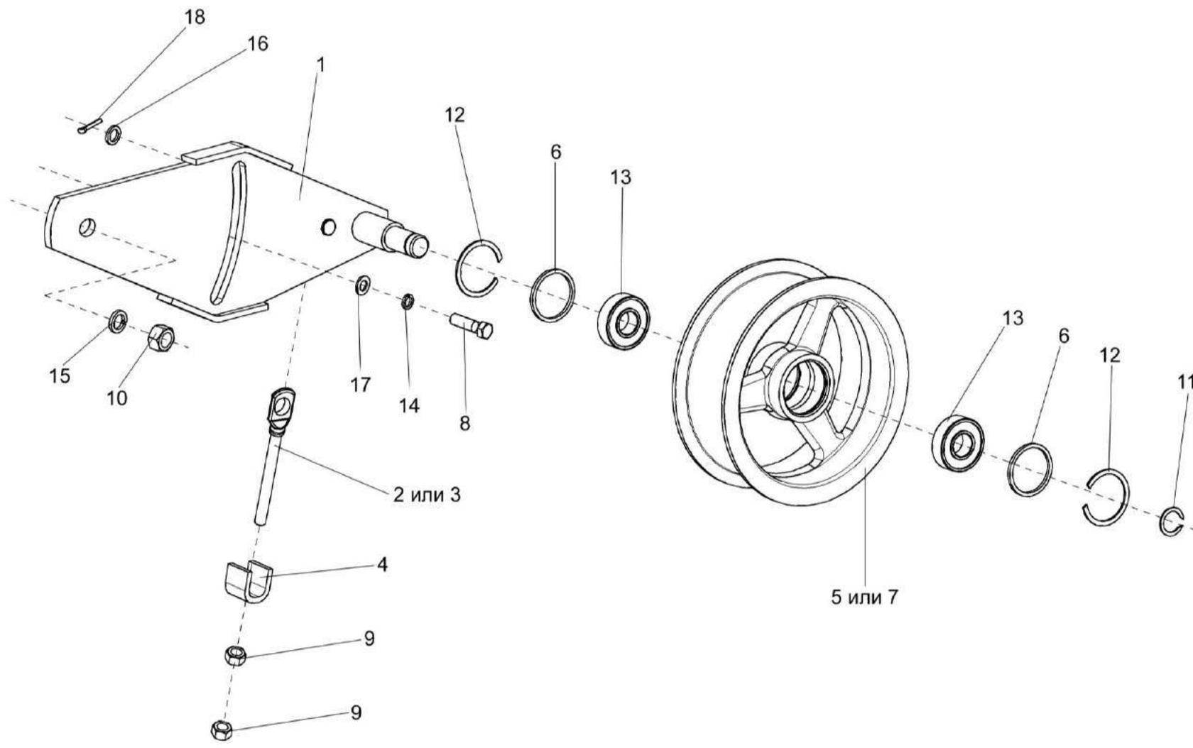
Рисунок 77 - Устройство натяжное МКС 0533000
