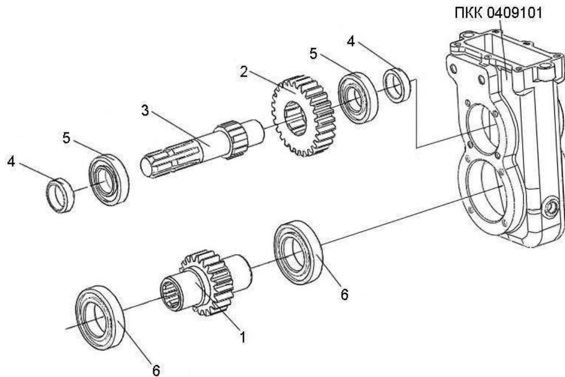
Рисунок 62 - Редуктор ПКК 0409000 (валы и шестерни)
