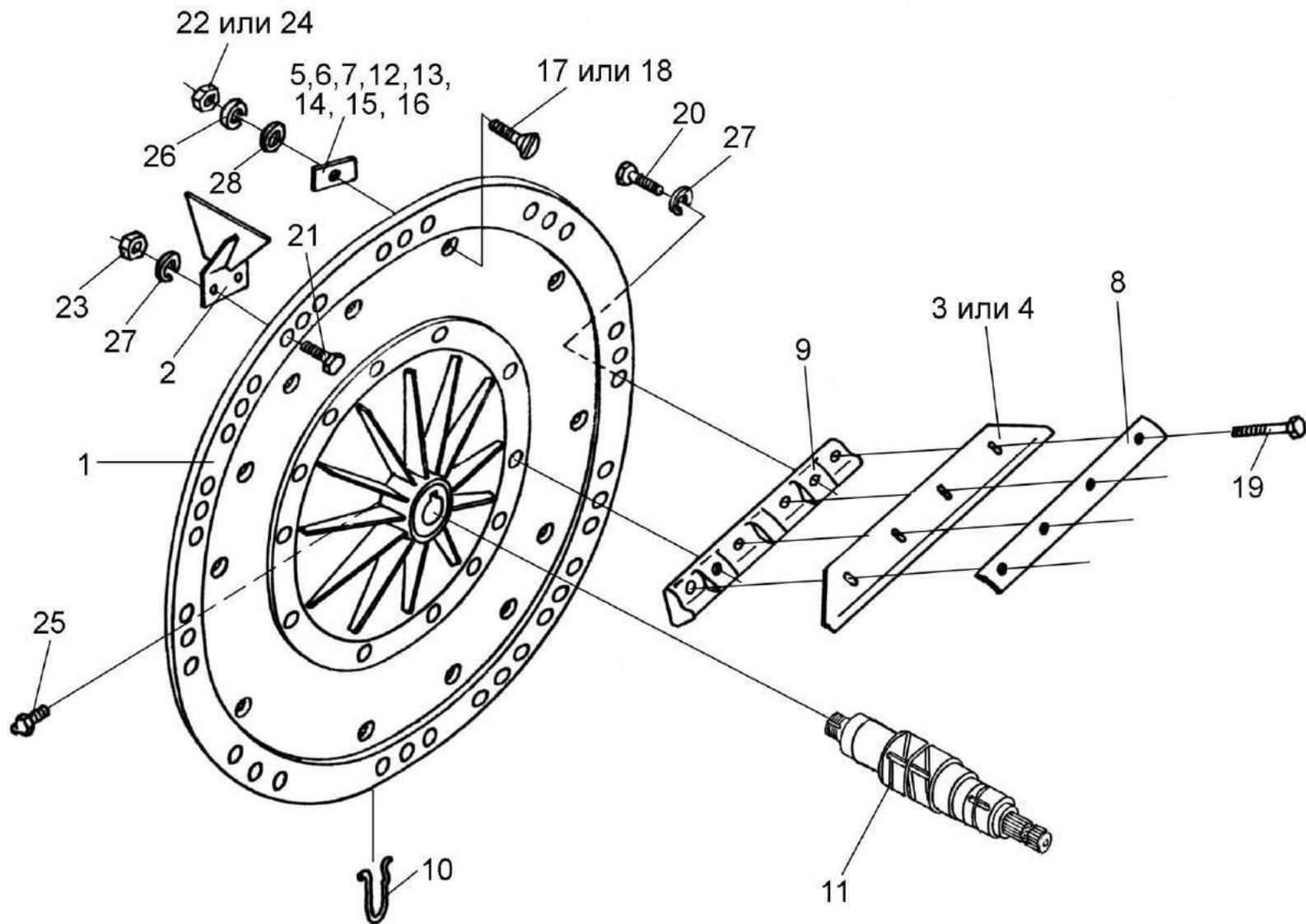
Рисунок 46 – Вал с ротором ПКК 0100560
