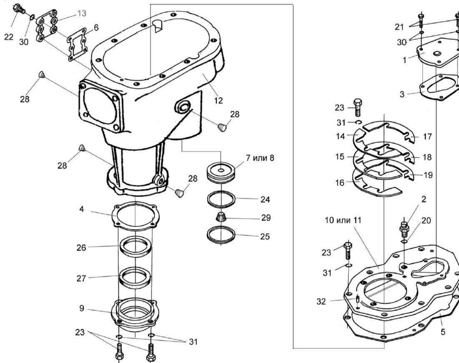
Рисунок 92 – Редуктор ПКК 0202860 (корпус и крышки)
