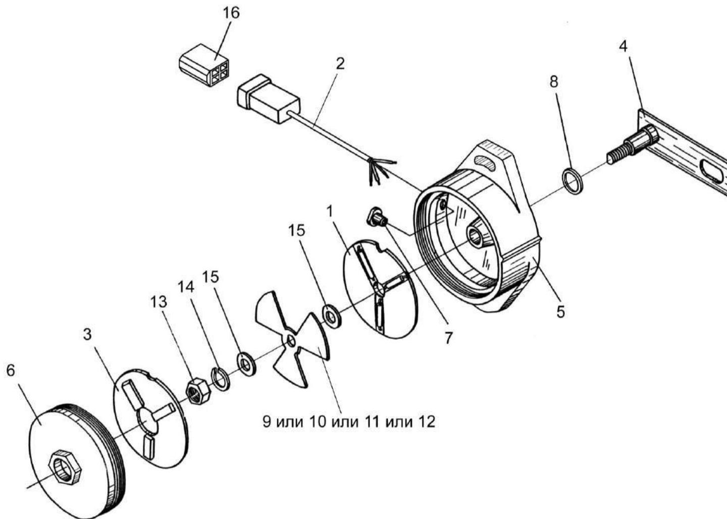
Рисунок 50 – Датчик положения ПКК 0152000В
