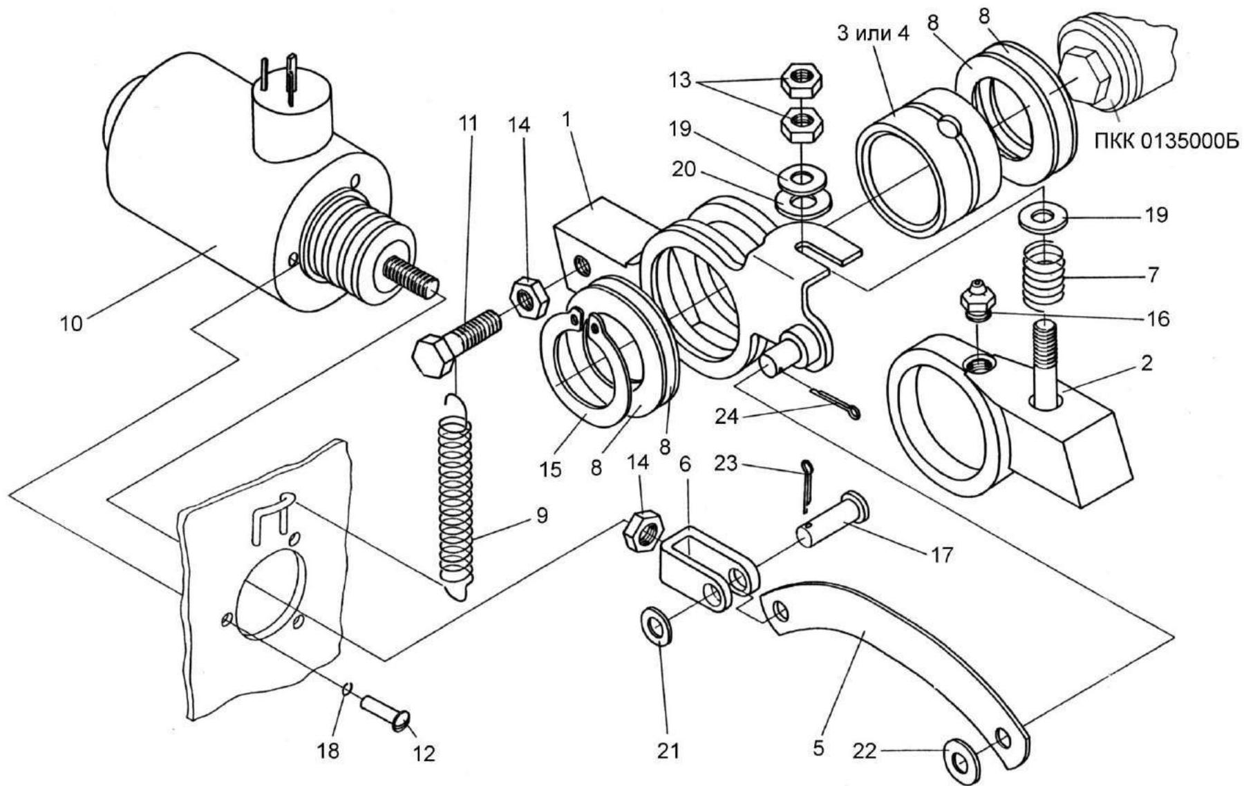
Рисунок 35 – Механизм быстрого останова
