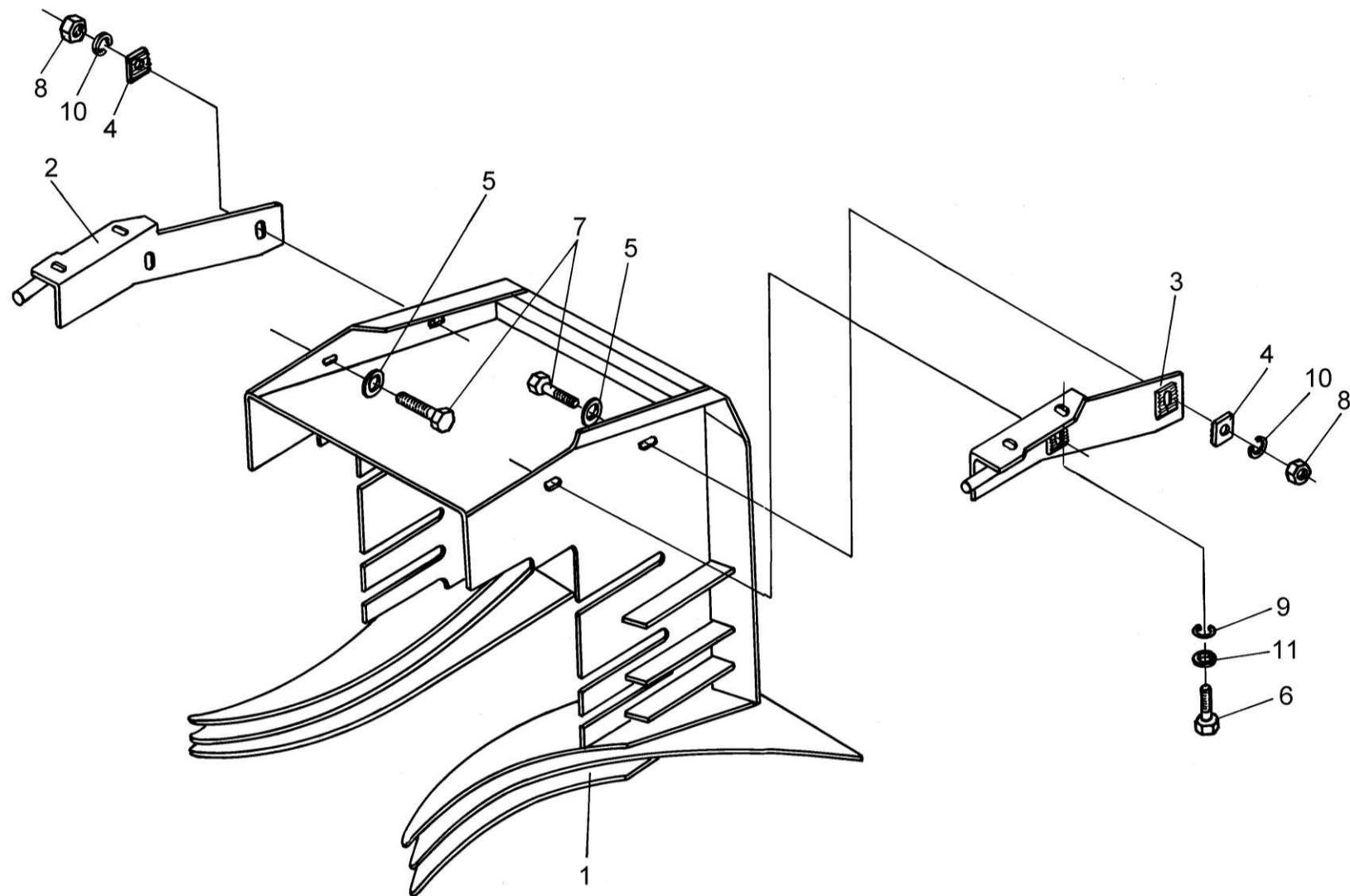
Рисунок 85 – Кожух скребка ПКК 0204030, державка ПКК 0204040
