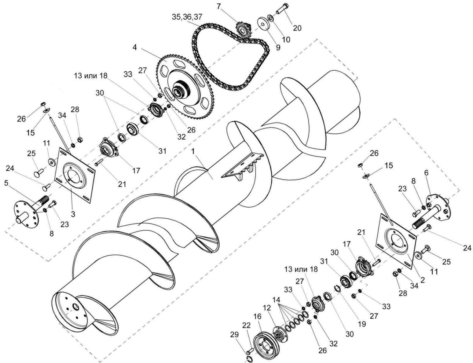
Рисунок 59 - Установка шнека
