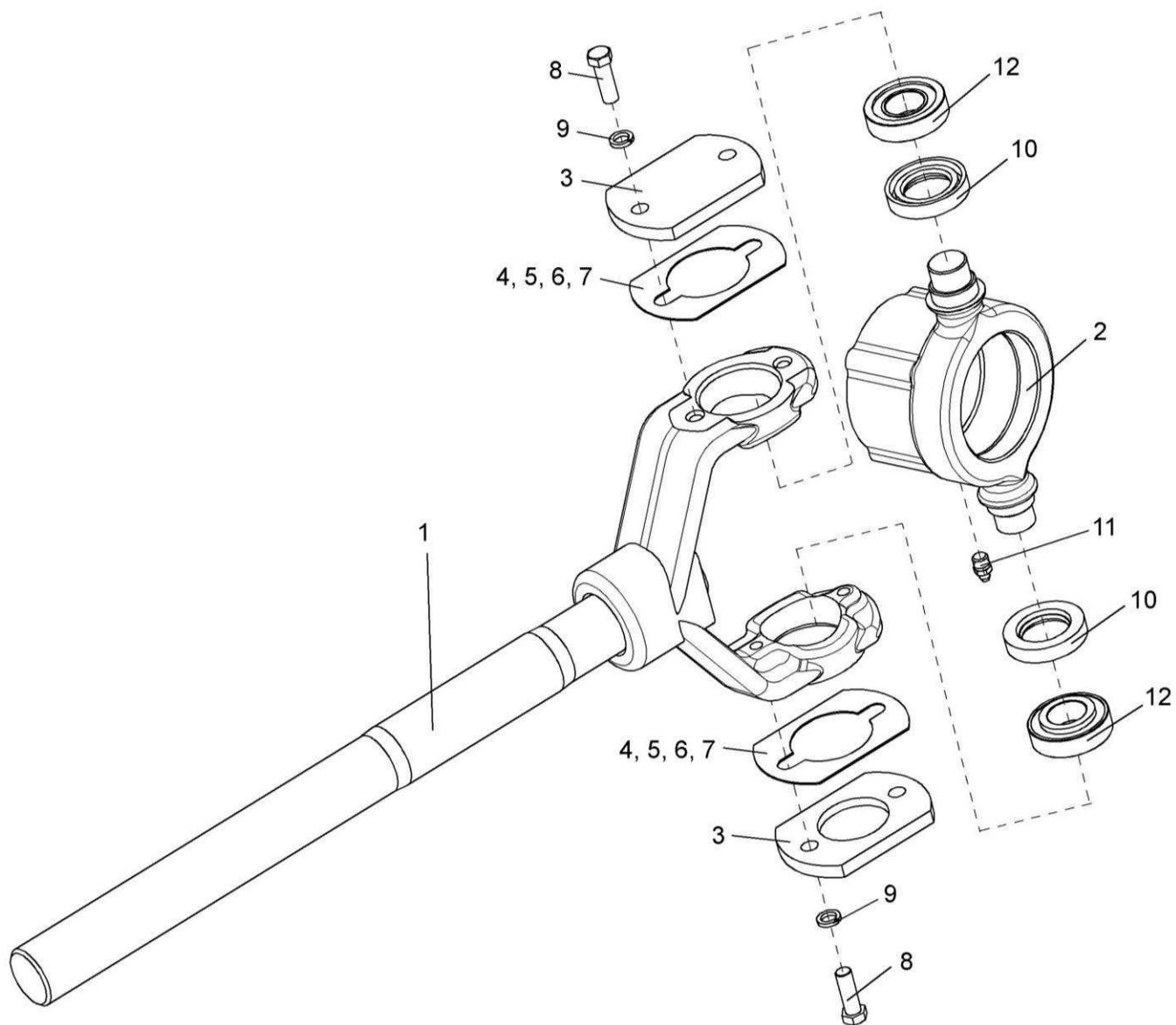
Рисунок 74 – Колесатель КИС 0216030Б
