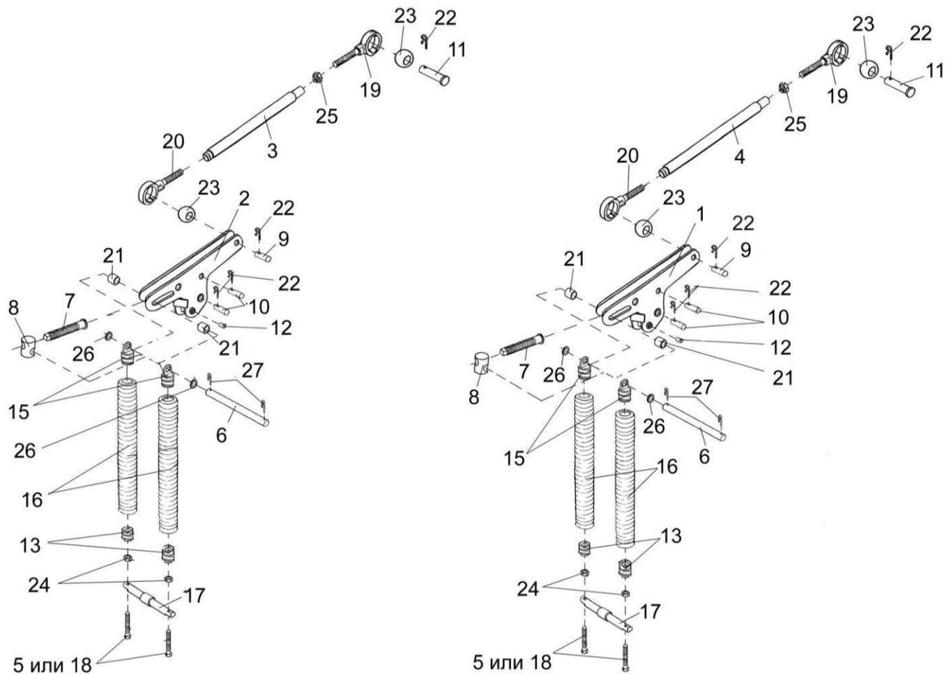
Рисунок 53 – Механизмы продольного копирования ПКК 0455000 и ПКК 0455000-01
