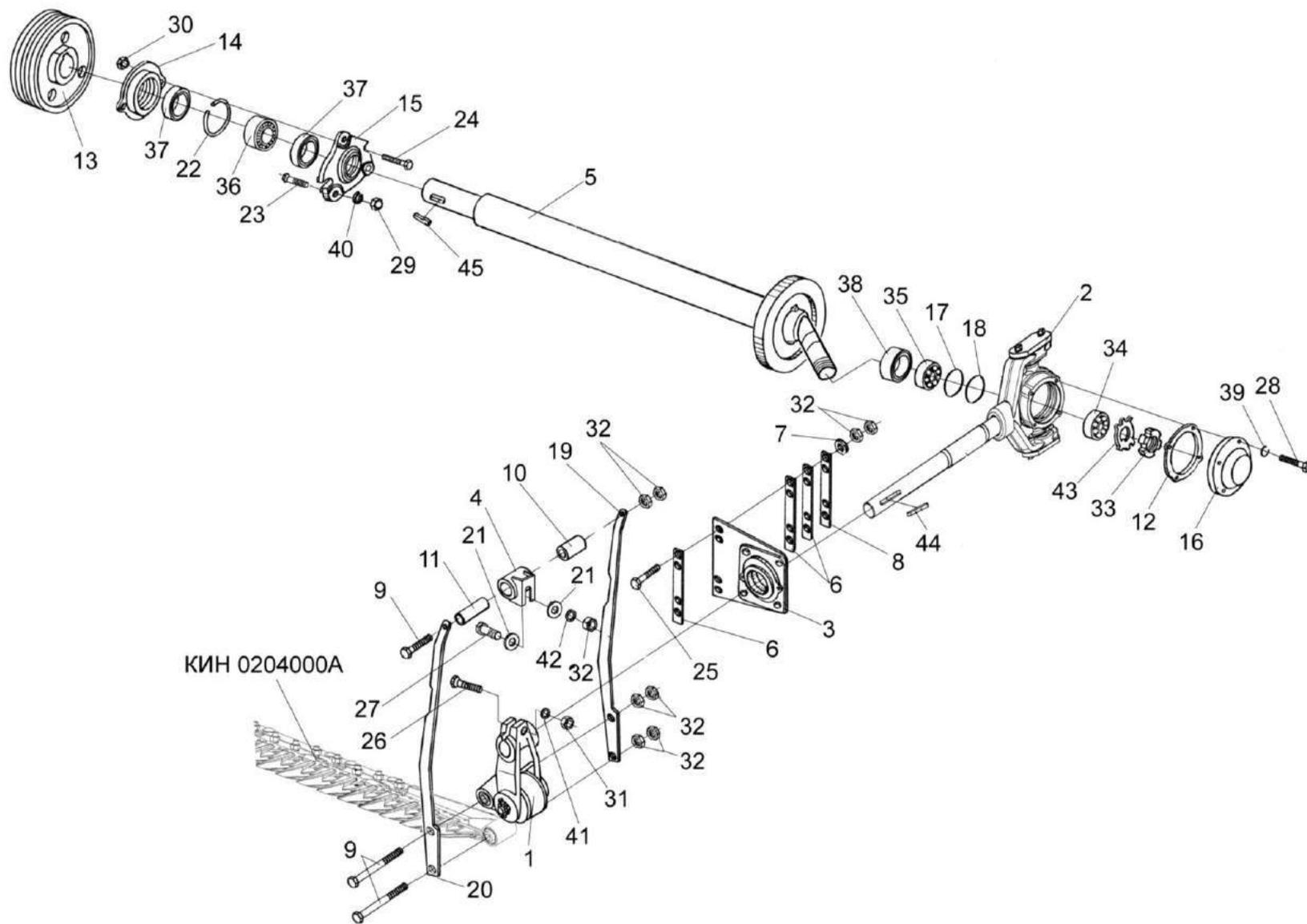
Рисунок 72 - Привод режущего аппарата жатки
