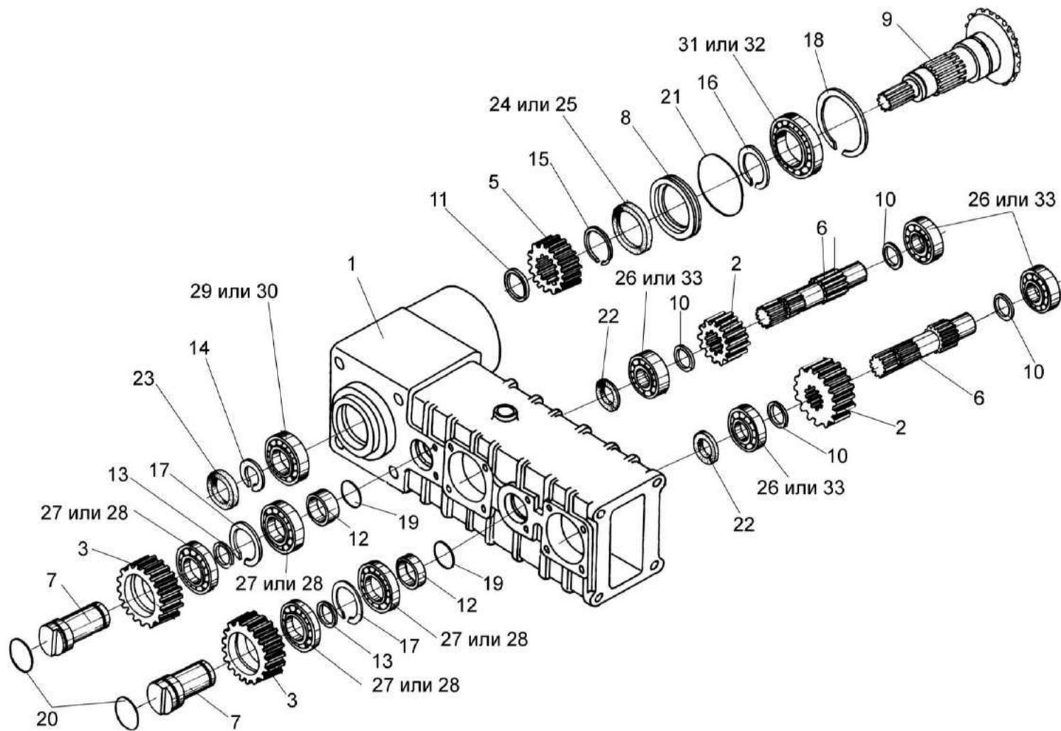
Рисунок 95 – Редуктор цилиндрический ПКК 0202890 (валы и шестерни)
