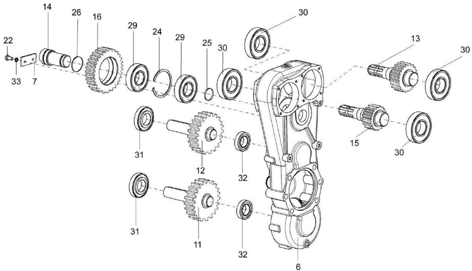
Рисунок 31 – Редуктор цилиндрический ПКК 0135170 (лист 2)
