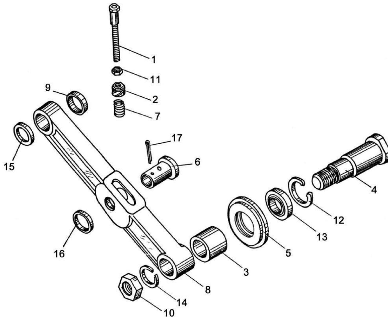
Рисунок 104 – Устройство натяжное КИС 0916000
