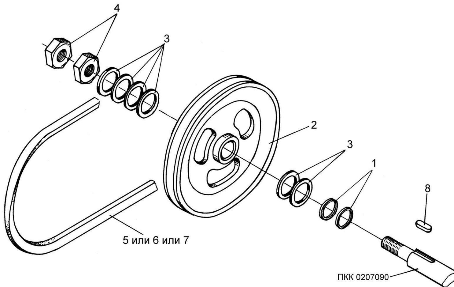
Рисунок 88 – Шкив привода делителя ПКК 0207108
