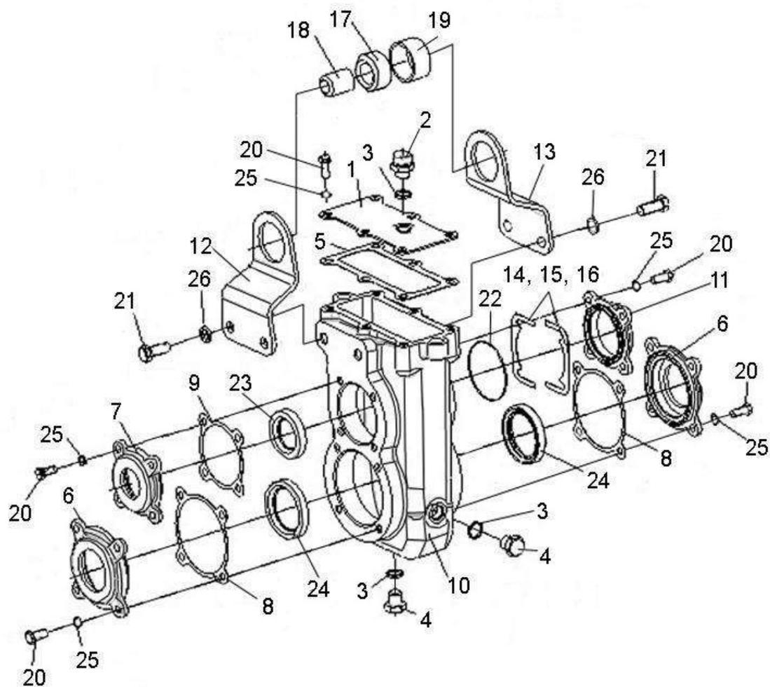
Рисунок 61 - Редуктор ПКК 0409000 (корпус и крышки)
