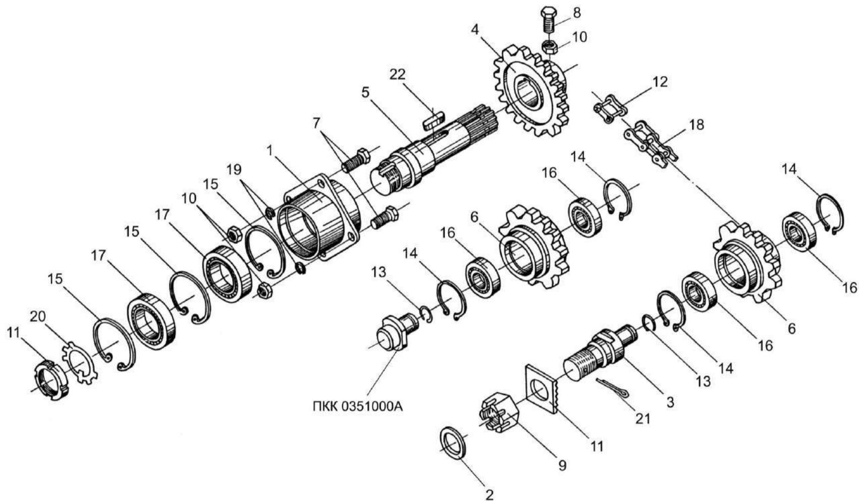
Рисунок 102 – Установка звездочек ПКК 0355000, ПКК 0356000
