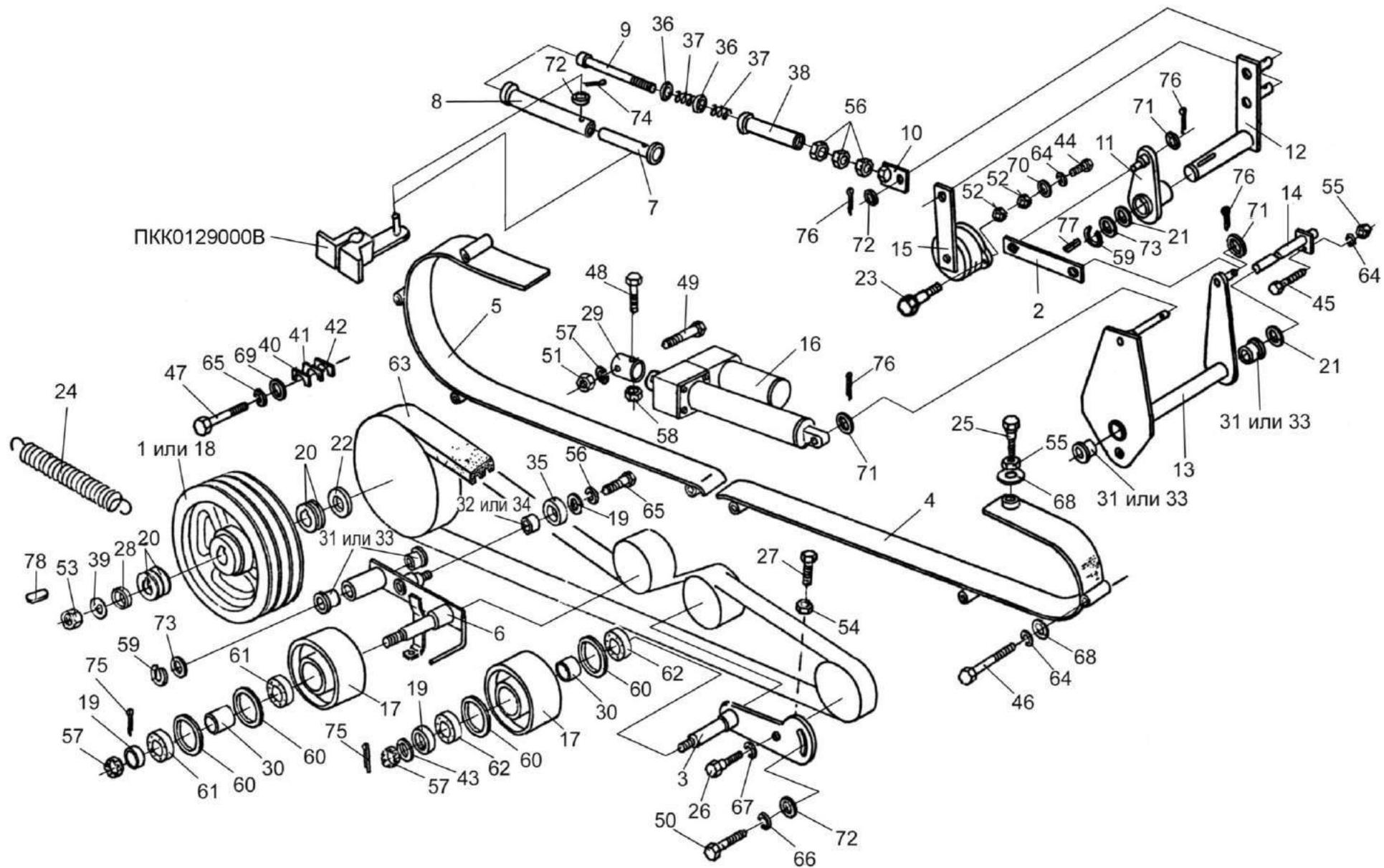
Рисунок 44 – Шкивы, ограждения привода ротора измельчителя
