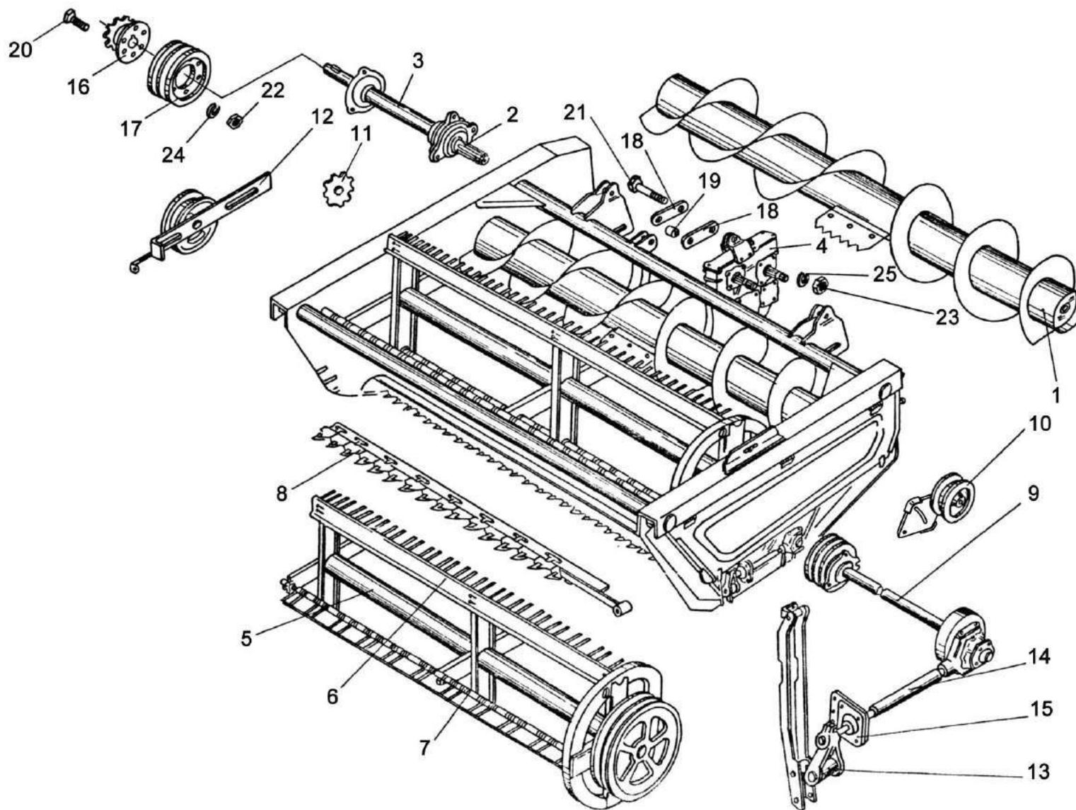
Рисунок 57 - Жатка для уборки трав. Общий вид КПТ 0460000
