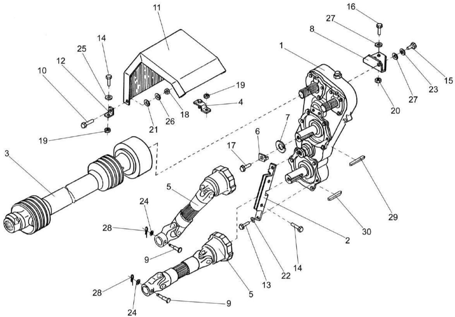
Рисунок 32 – Установка валов карданных ПКК 0140000 и ПКК 0145000
