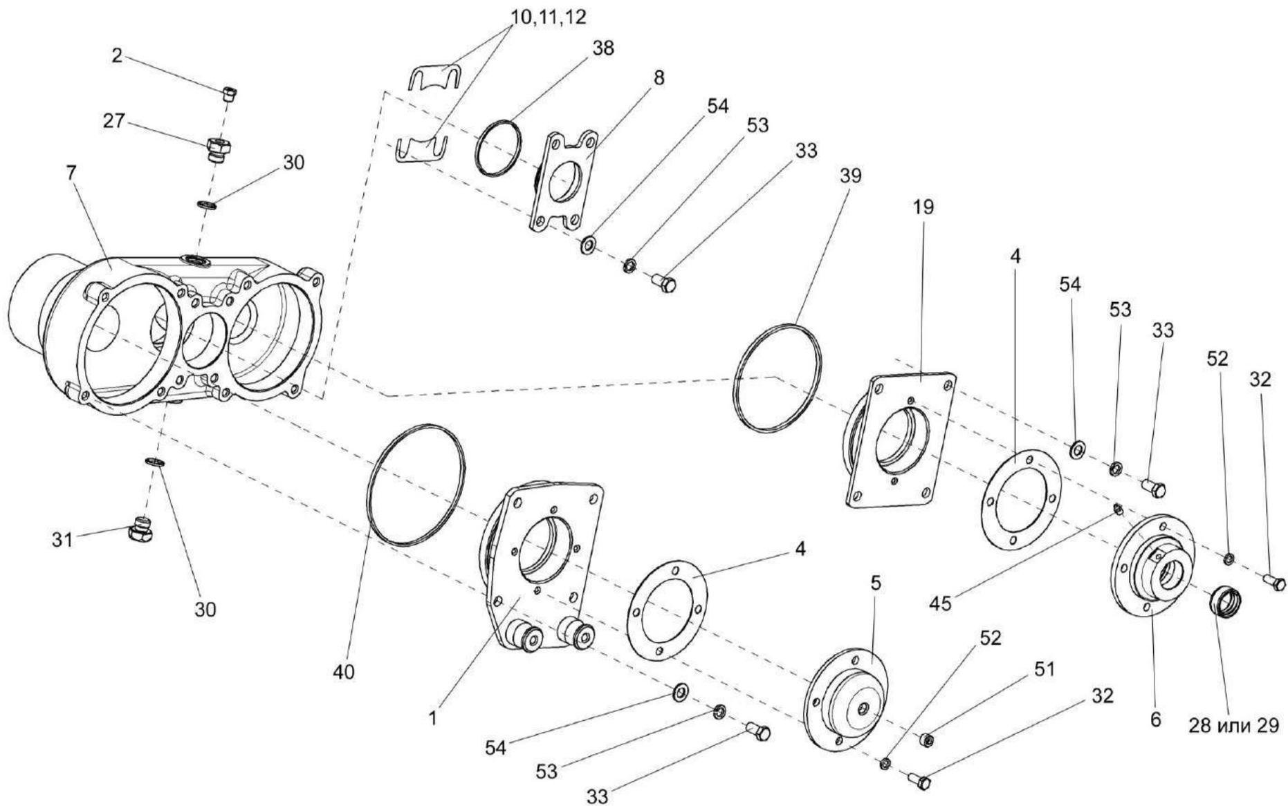
Рисунок 41 – Редуктор цилиндрический подпрессовывающих вальцев ПКК 0118000Б (лист 1)
