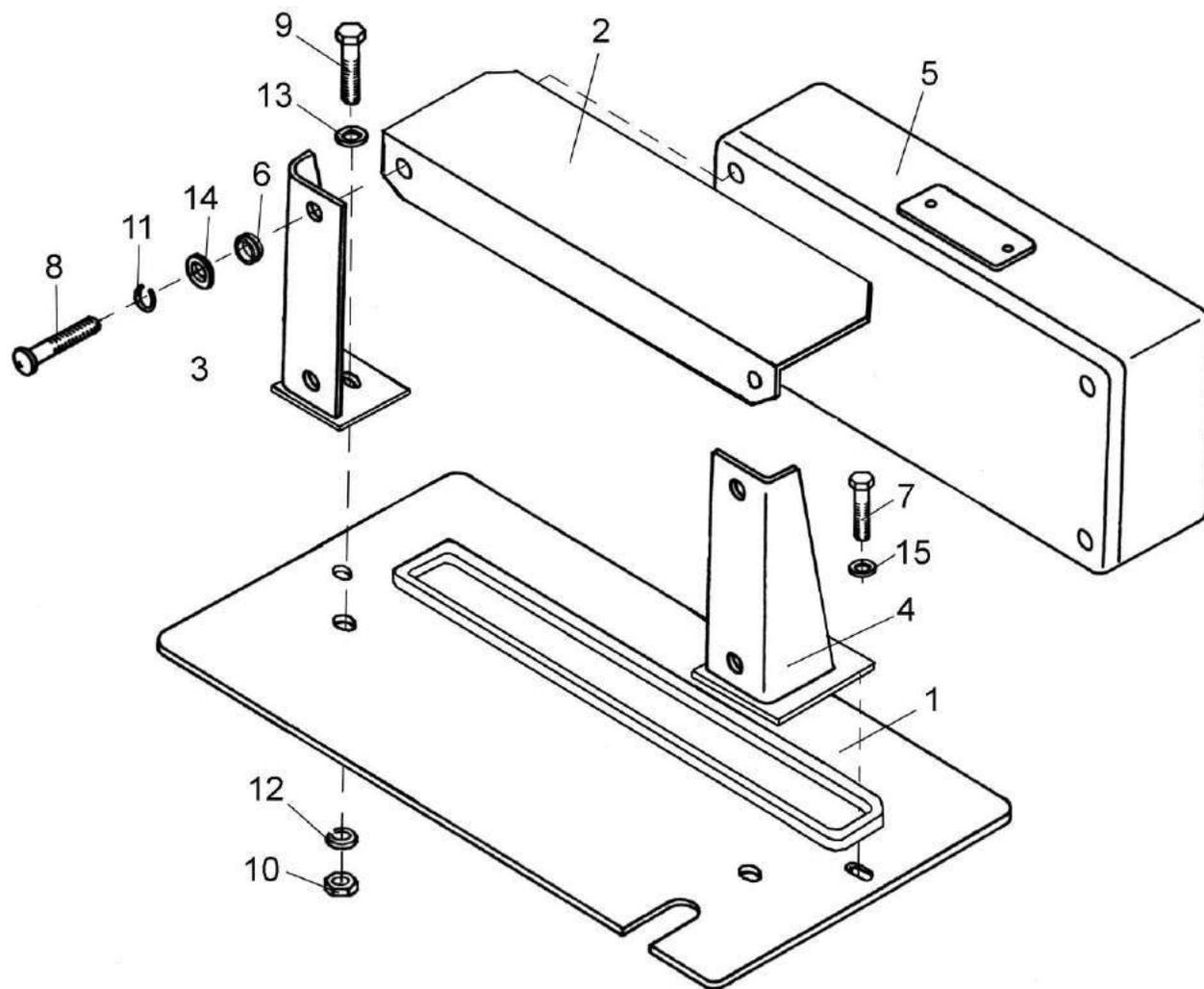
Рисунок 23 – Панель ПКК 0100030Б
