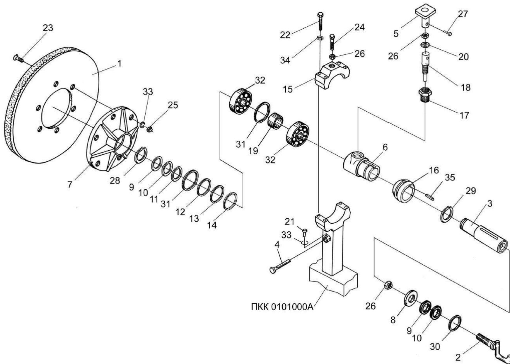
Рисунок 48 – Устройство заточное ПКК 0107000Б
