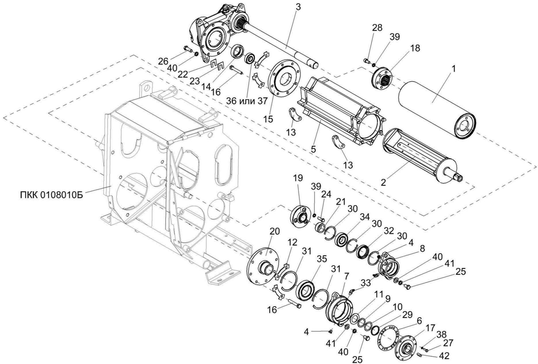
Рисунок 37 – Аппарат питающий ПКК 0108000Б (установка редуктора ПКК 0117000А)
