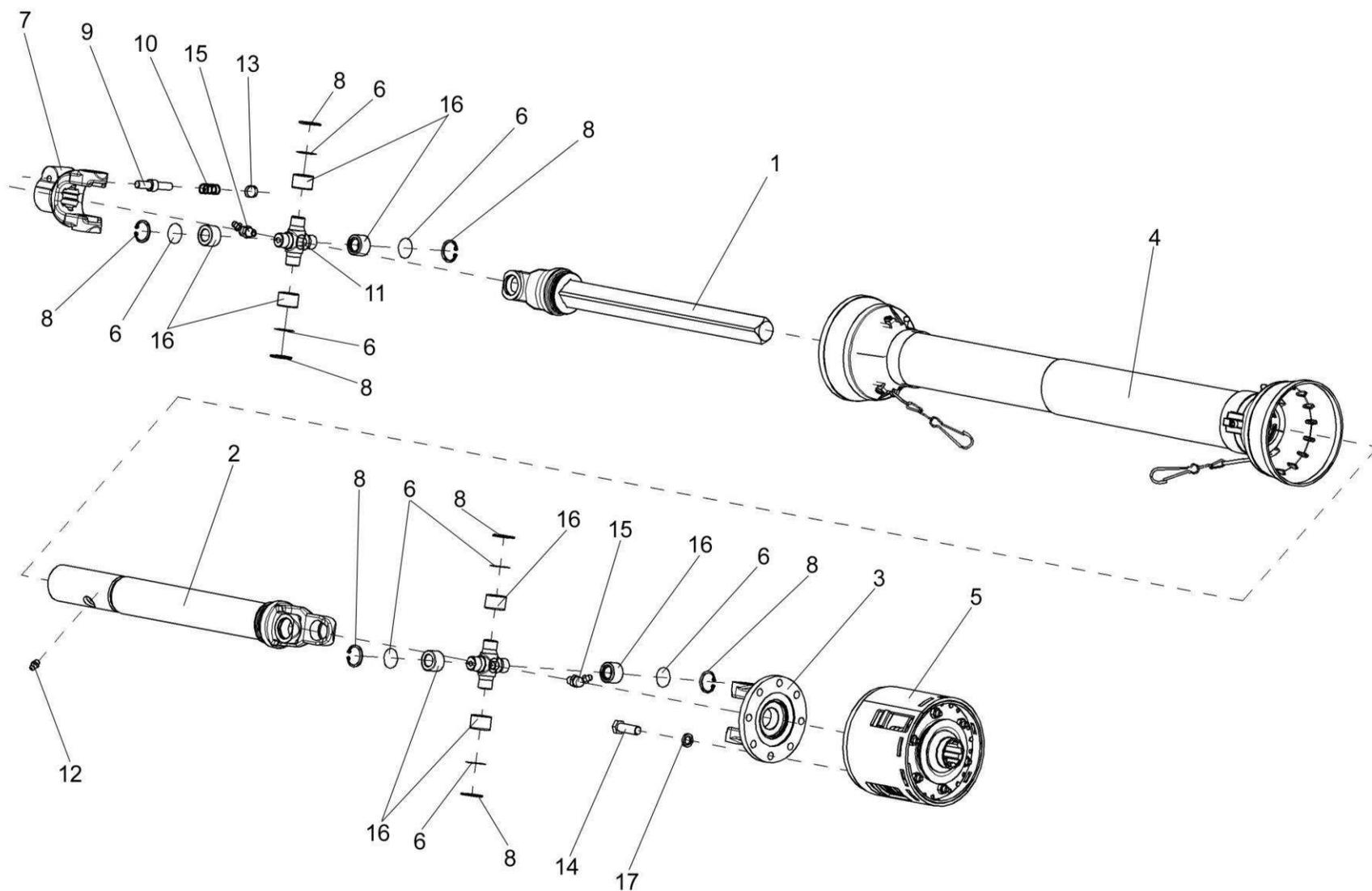
Рисунок 33 – Вал карданный телескопический с защитным кожухом ПКК 0140000
