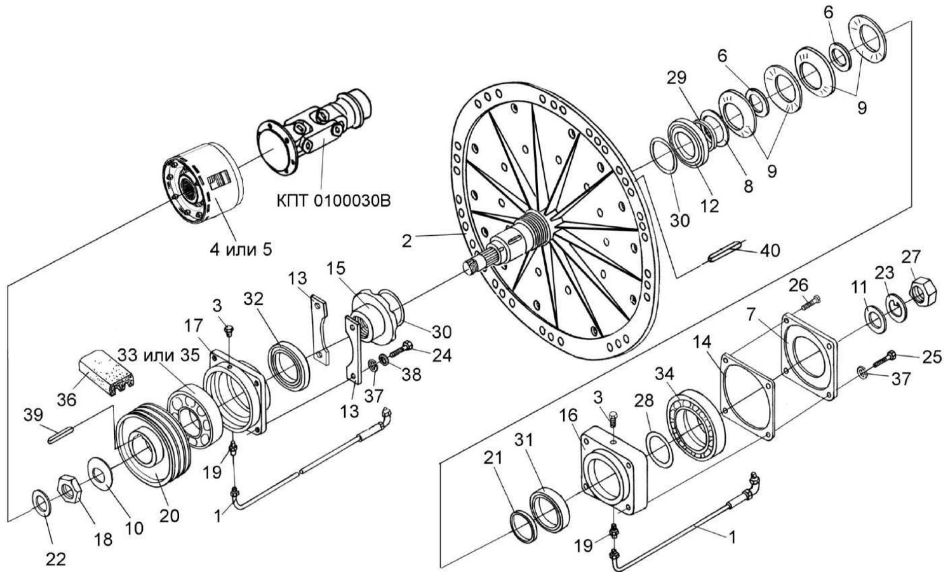
Рисунок 45 – Привод ротора измельчителя
