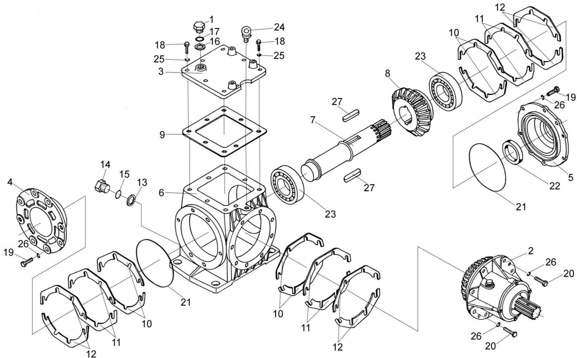
Рисунок 12 – Редуктор конический КПТ 0104000Б
