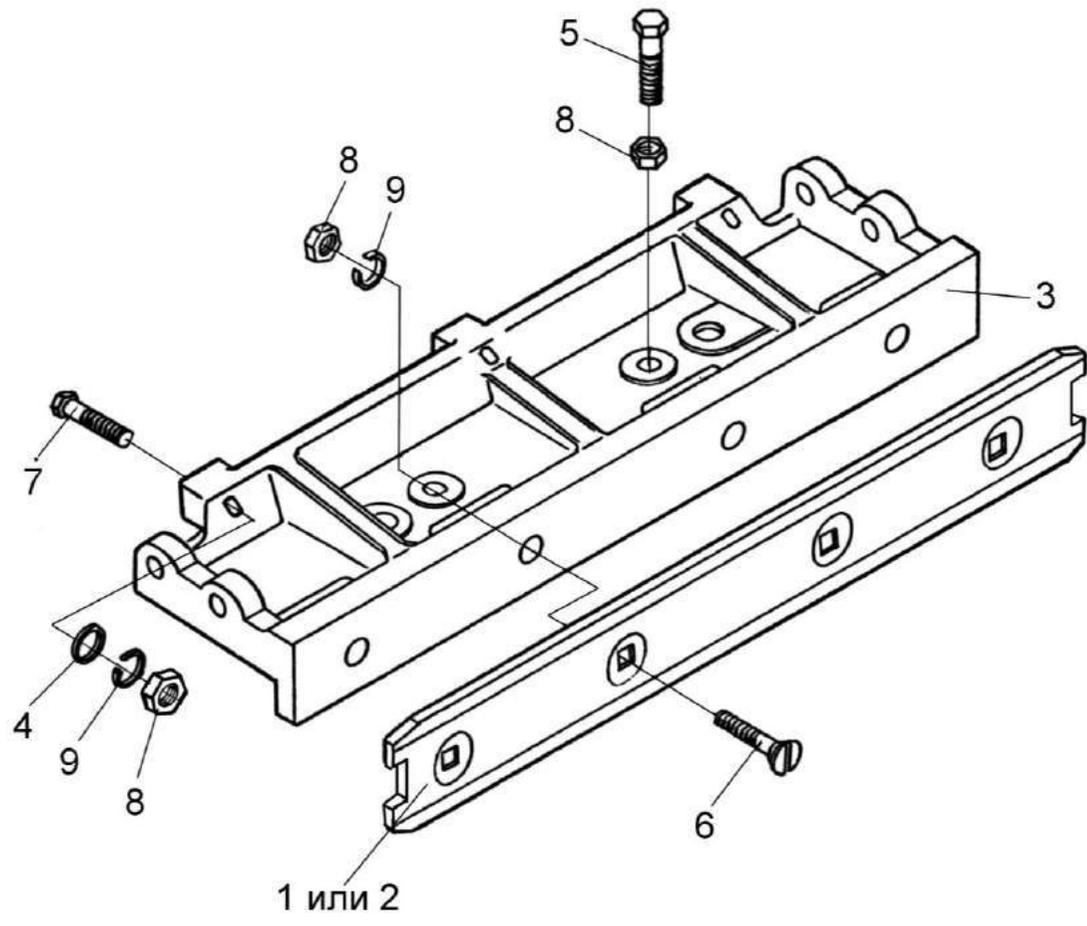
Рисунок 49 – Противорез ПКК 0100170
