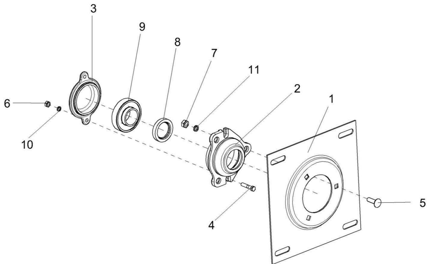
Рисунок 69 - Плита с подшипником КИС 0203050Б
