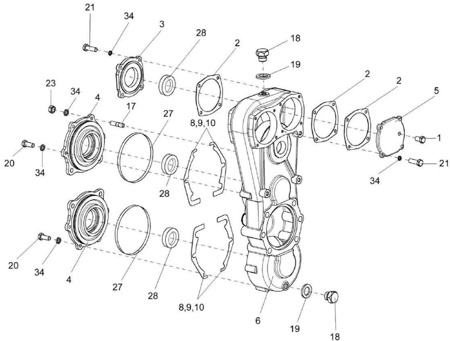
Рисунок 30 – Редуктор цилиндрический ПКК 0135170 (лист 1)
