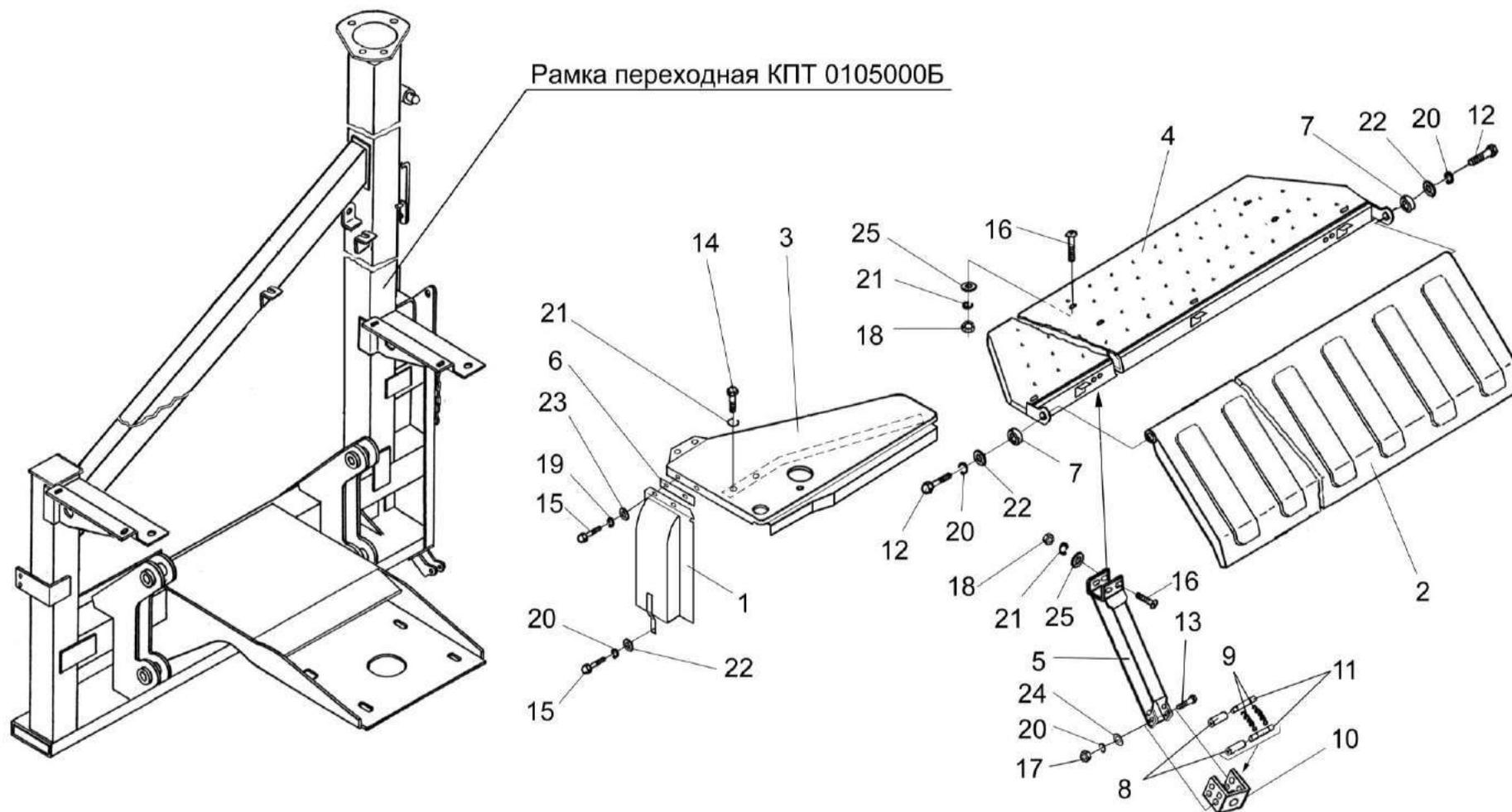
Рисунок 6 – Настил, ограждения, опоры
