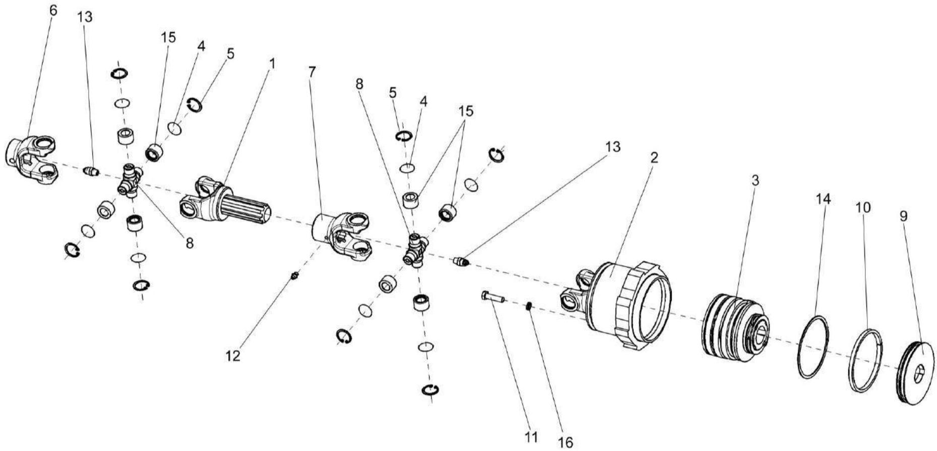
Рисунок 34 – Вал карданный телескопический с муфтой ПКК 0145000
