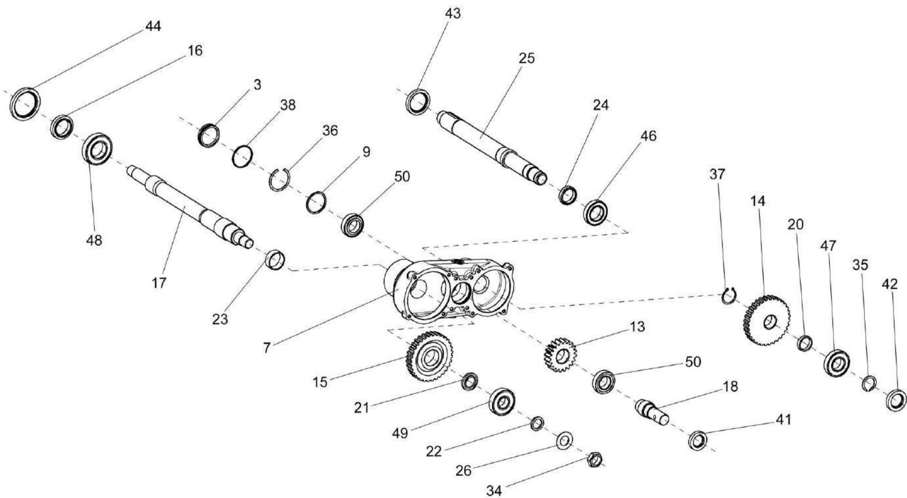
Рисунок 42 – Редуктор цилиндрический подпрессовывающих вальцев ПКК 0118000Б (лист 2)
