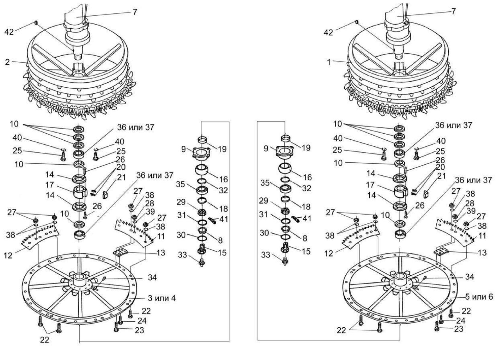
Рисунок 89 – Барабаны с приводом ПКК 0202300
