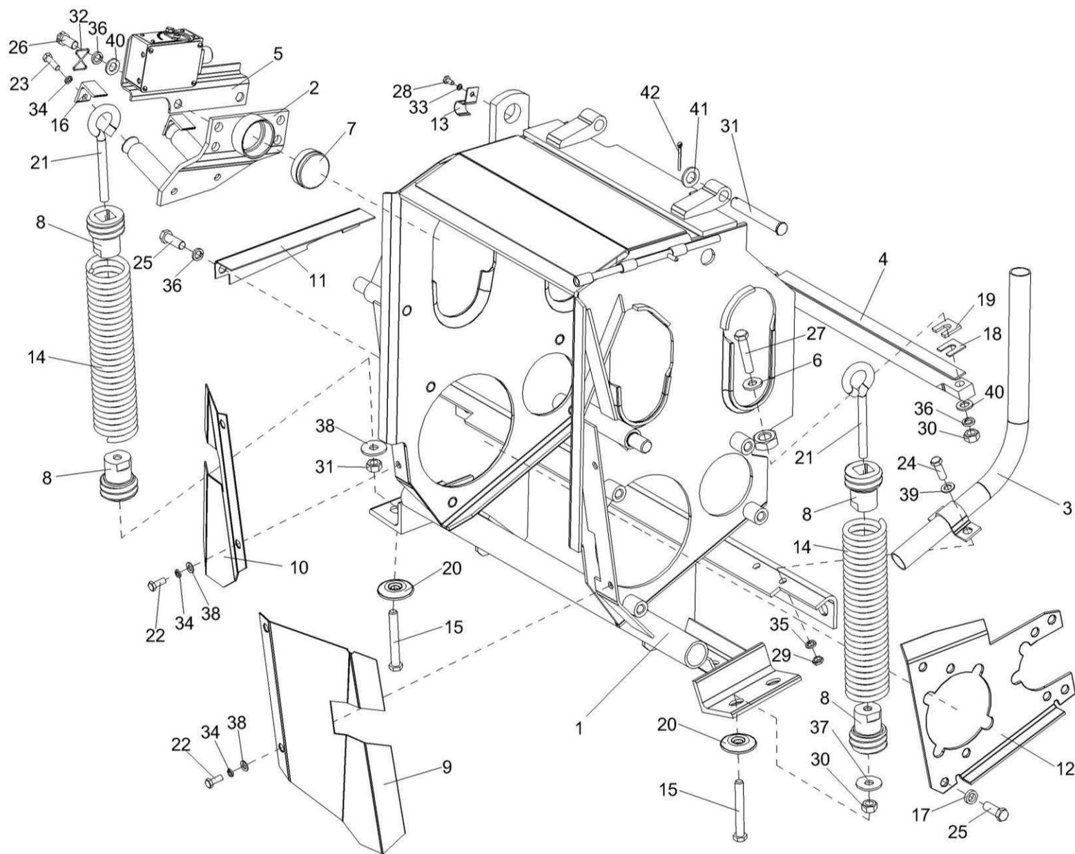
Рисунок 36 – Аппарат питающий ПКК 0108000Б (корпус, щитки, пружины)
