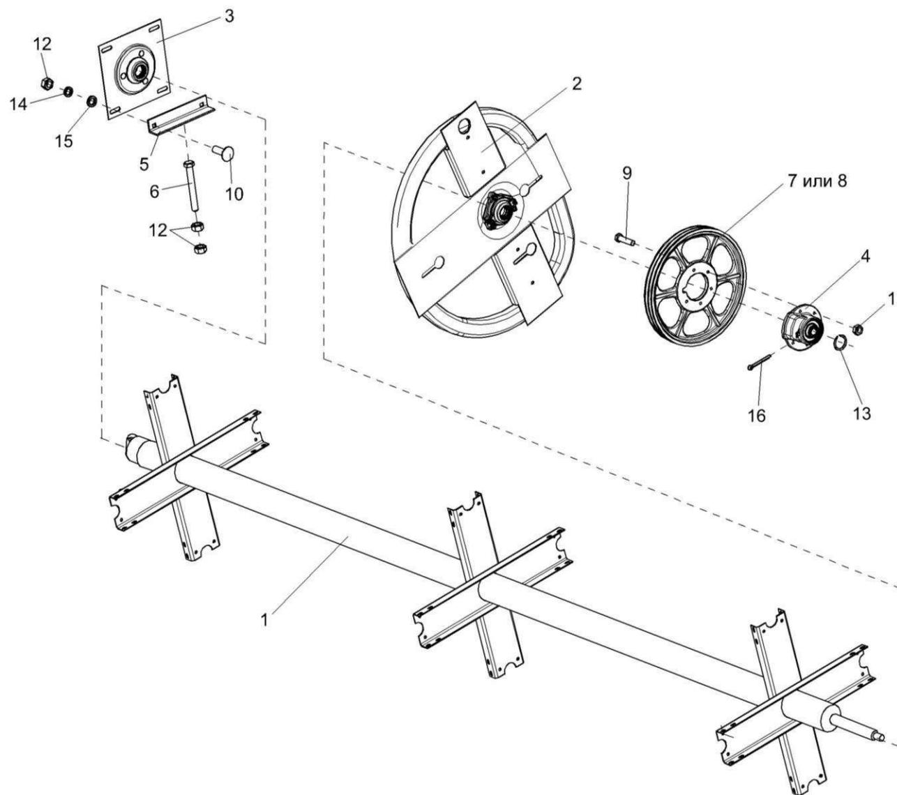
Рисунок 65 - Мотовило (установка дорожки, плиты с подшипником, муфты обгонной)
