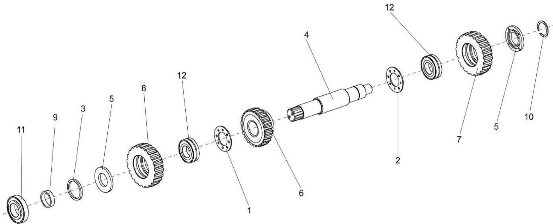
Рисунок 27 – Вал ПКК 0135030Б
