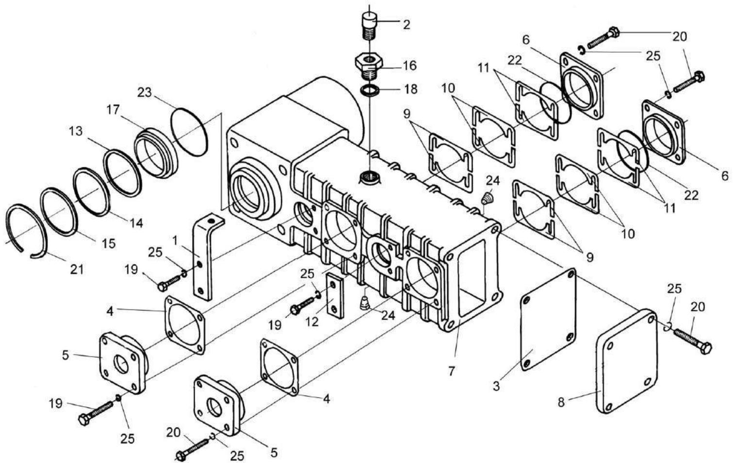
Рисунок 94 – Редуктор цилиндрический ПКК 0202890 (корпус и крышки)
