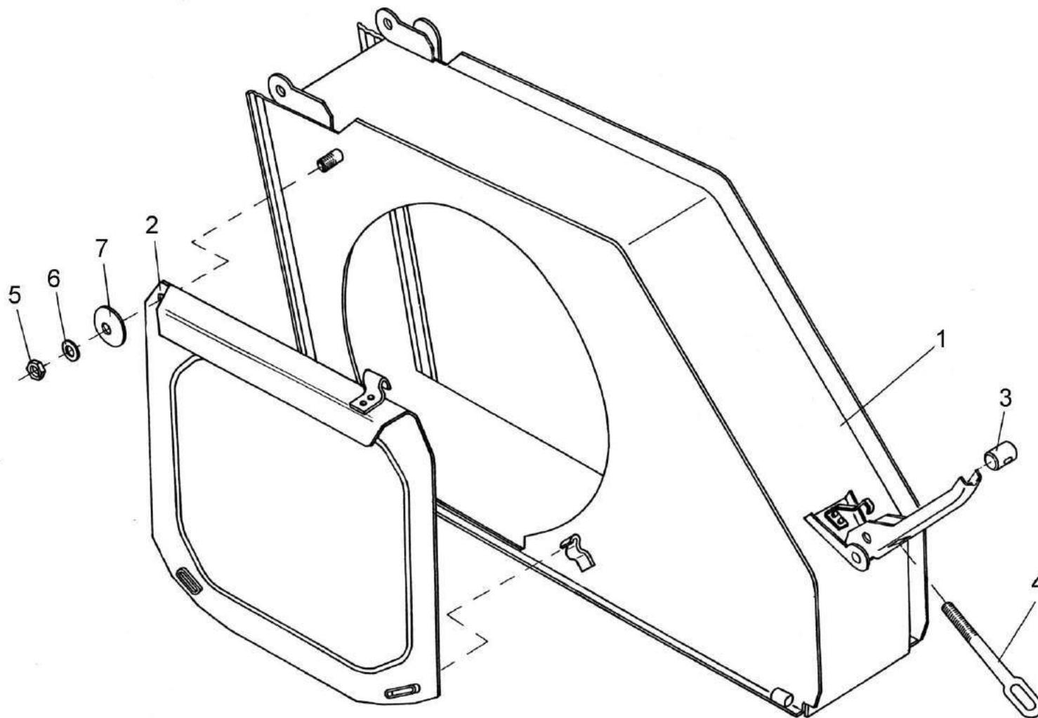
Рисунок 22 – Кожух верхний измельчителя ПКК 0103000А
