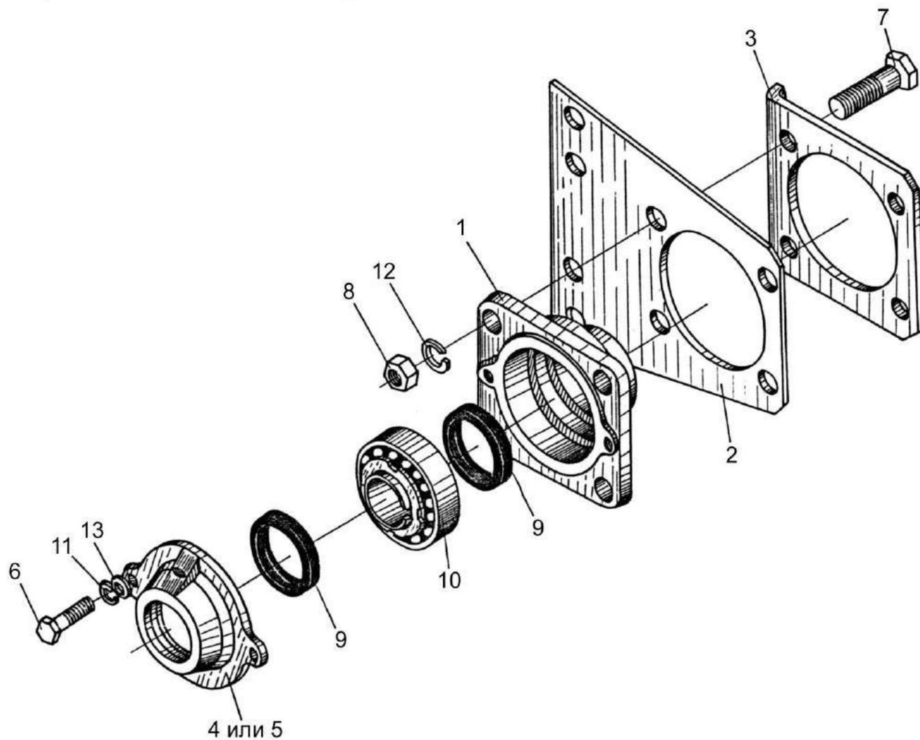
Рисунок 75 - Опора промежуточная КИС 0216040Б
