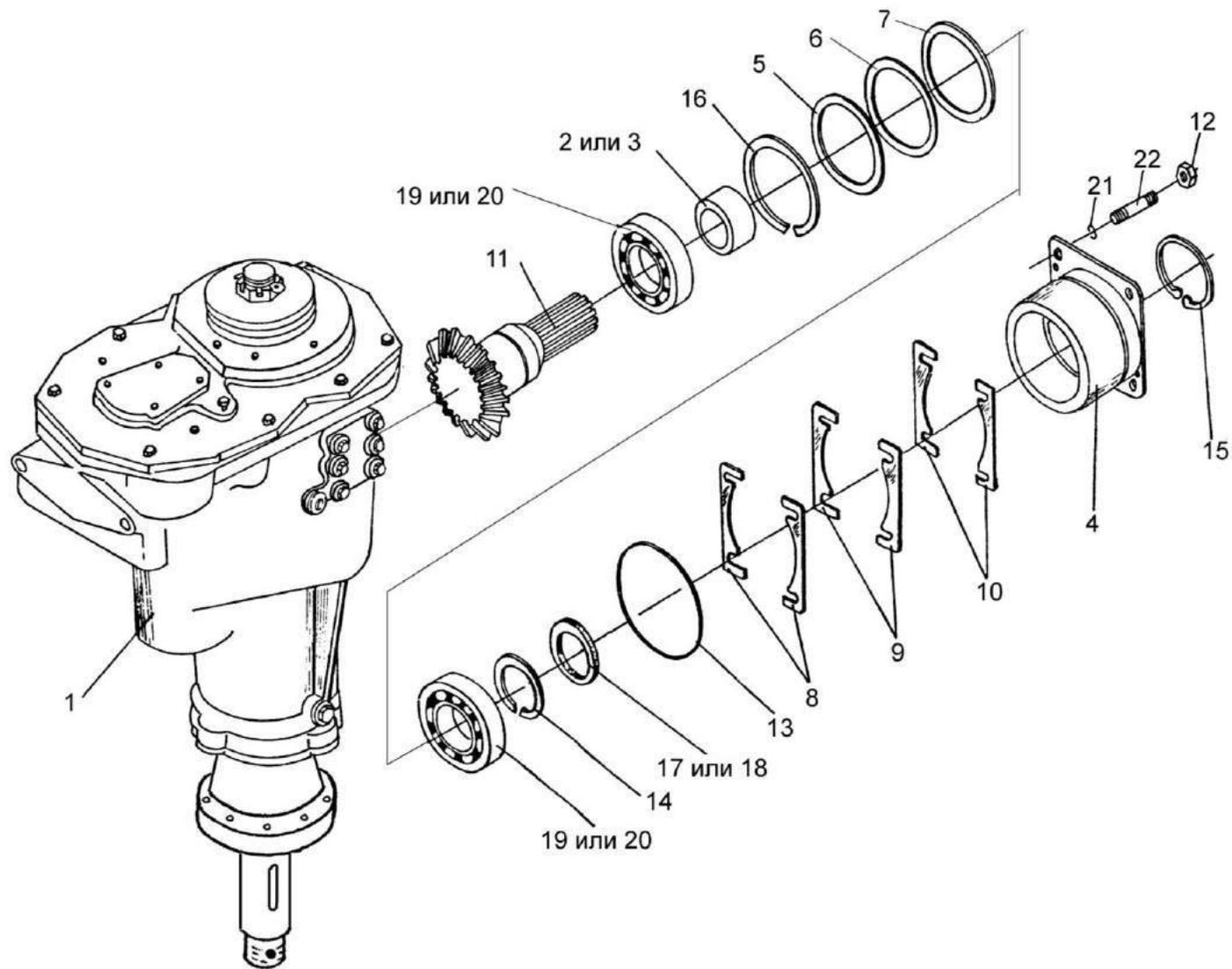
Рисунок 91 – Редуктор конический ПКК 0202850
